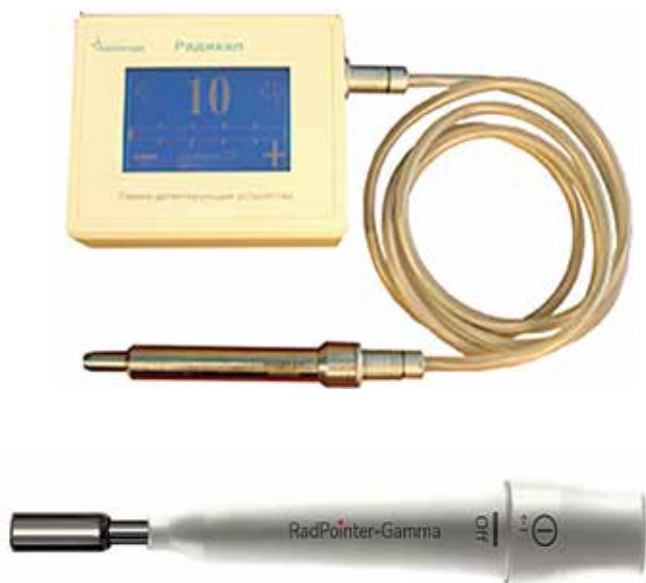
Рис. 4. Ручные гамма-зонды: а – гамма-детектирующее устройство для поиска сторожевых лимфатических узлов «Радикал»; б – портативный беспроводной детектор RadPointer-Gamma для предоперационного обнаружения и интраоперационной локализации сигнальных лимфатических узлов, маркированных радиоактивной меткой
