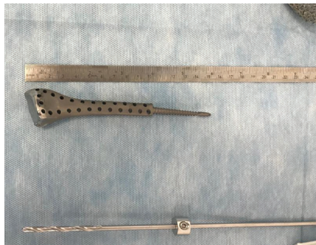
Рис. 15. Вид сверху эндопротеза правой лучевой кости. Эндопротез выполнен из сплава титана методом 3D-печати Fig. 15. Top view of the right radius graft. The graft is made of titanium alloy using 3D-printing
