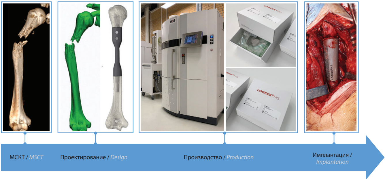
Рис. 1. Этапы проектирования и изготовления индивидуальных имплантатов. МСКТ – мультиспиральная компьютерная томография Fig. 1. Stages of designing and manufacturing individual implants. MSCT – multislice computed tomography
