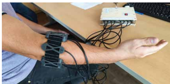
Рис. 1. Расположение датчиков в верхней трети предплечья Fig. 1. Sensors arrangement in the upper third of the forearm
