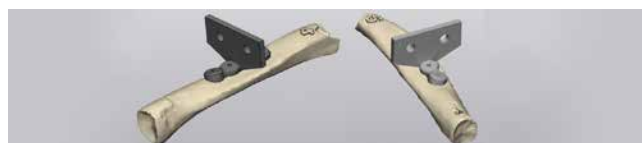
Рис. 3. Образец крепления имплантата с помощью винтов, расположенных под углом 90° к кости с поворотом на 10° вправо и влево в шахматном порядке
