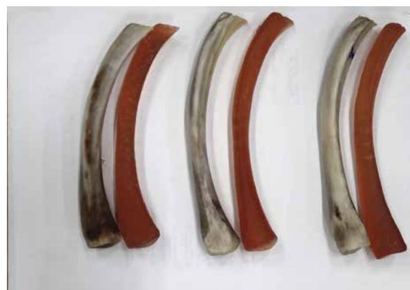
Рис. 8. Свиные ребра и макеты костей, изготовленные из фотополимера Fig. 8. Porcine ribs and bone mock-ups made of photopolymer
