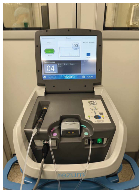
Радиочастотный генератор, главная задача которого состоит в испарении стерильной воды и контроле количества энергии, подаваемой в ткань предстательной железы
