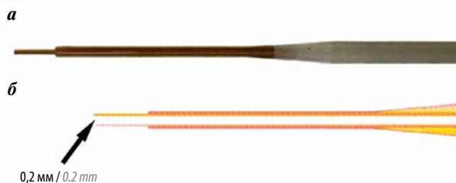
Рис. 1. Канюля для интрапаренхиматозного введения: а — фото канюли с внешней керамической оболочкой; б — схема канюли в разрезе: внутренняя кварцевая трубка (стрелка) диаметром 0,2 мм
