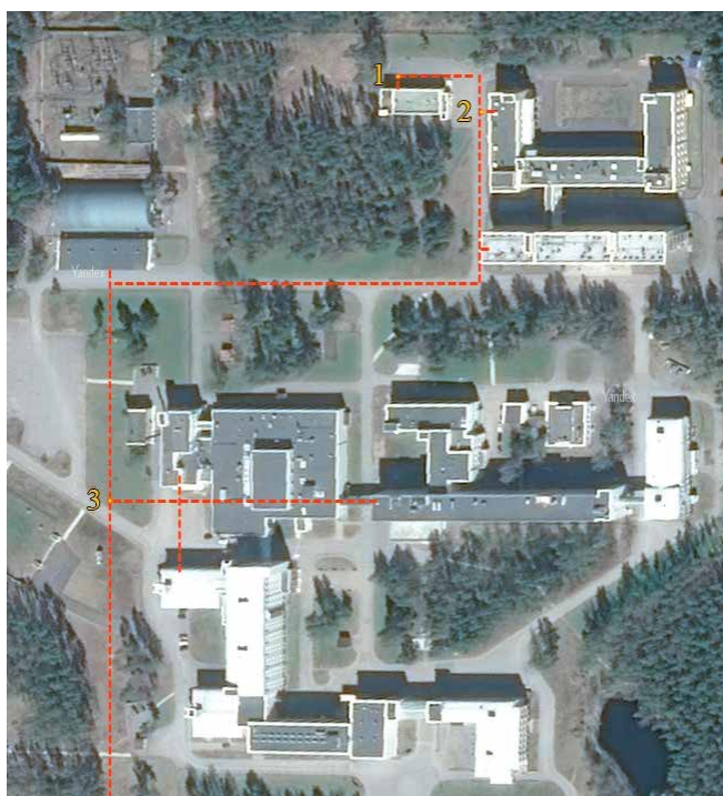
Рис. 1. Схема системы водоотведения Российского научного центра радиологии и хирургических технологий им. акад. А.М. Гранова (Центр) (красные пунктирные линии) и точки отбора проб сточных вод (желтые точки). Точка 1 – непосредственно у корпуса радионуклидной диагностики и терапии, куда поступают воды только из одного туалета пациентов отделения; точка 2 – объединение потоков сточных вод из всего корпуса радионуклидной диагностики и терапии и соседнего корпуса (отбор осуществляли в точке до слияния 2 потоков); точка 3 – на выходе из всего Центра с общим потоком сточных вод от всех корпусов Центра
