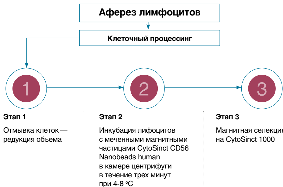
Рисунок 2. Технологическая цепочка производства NK-клеток
