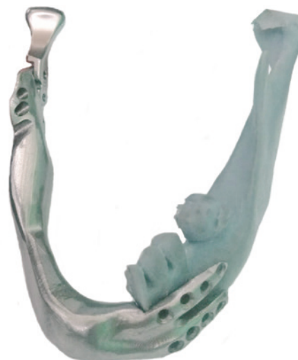
Рис. 6. Предварительная сборка челюстного имплантата и FDM-модели нижней челюсти
